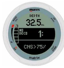
Cuando el nivel de toxicidad de oxígeno alcance el 100%, aparecerá el mensaje de alarma CNS > 100%. El mensaje de alarma y la señal sonora se repiten durante 5 segundos en intervalos de un minuto tras la primera detección y hasta que el valor del CNS sea del 100% o inferior. ¡Considere finalizar la inmersión de inmediato!
