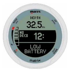
La vida útil de la pila recargable es de aproximadamente 500 ciclos de carga. Póngase en contacto con su distribuidor autorizado de Mares si necesita sustituirla.
