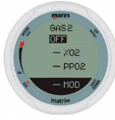
Puede comprobar todos los gases configurados desde la pantalla de preinmersión, manteniendo pulsado el botón superior derecho.
