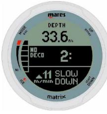
Si la velocidad de ascenso excede los 12 m/ min a profundidades superiores a los 12 m, el mensaje de la pantalla cambiará a **T00 FAST** (demasiado rápido). Si se mantiene una velocidad superior a 12 m/min durante dos tercios o más de la profundidad a la que se disparó la alarma en primer lugar, Matrix lo considerará una violación de la inmersión y la pantalla mostrará .
