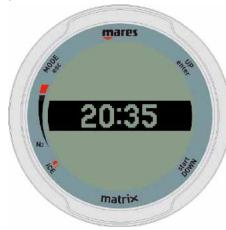
Para cambiar lo que se muestra en la parte superior de la pantalla, pulse el botón superior derecho. Puede elegir entre un campo en blanco, la fecha actual, la hora de la alarma configurada y la hora secundaria (útil cuando se viaja a una zona horaria distinta).
