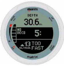
En este caso, si el buceador intenta realizar una inmersión sucesiva tras salir a la superficie, Matrix solamente funcionará como profundímetro y cronómetro (modo profundímetro) y mostrará el mensaje **LOCKED** (bloqueado) en el centro de la pantalla.
