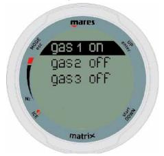
Una vez dentro de este menú, utilice los botones de la derecha para cambiar el  $O_2$ % y observe cómo se ve afectada la profundidad máxima operativa (MOD). A continuación, mantenga pulsado el botón derecho para pasar a la pp $O_2$ max y utilice los botones de la derecha para cambiar el valor, observando de nuevo cómo se ve afectada la MOD. Mantenga pulsado de nuevo el botón superior derecho para guardar los cambios y salir del menú.
