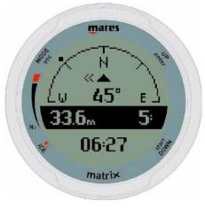
Si mantiene pulsado el botón inferior derecho, activará el cronómetro. Puede resultarle útil para cronometrar una manga del rumbo de navegación. Cada vez que mantenga pulsado el botón inferior derecho, el cronómetro volverá a comenzar desde 00:00. Si sale de la brújula, el cronómetro seguirá corriendo en segundo plano.
