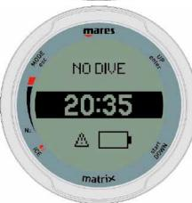
Puede consultar el nivel exacto de carga de la pila en la parte inferior de la pantalla, desplazándose por la información utilizando el botón inferior derecho (vea la sección 1.4).
